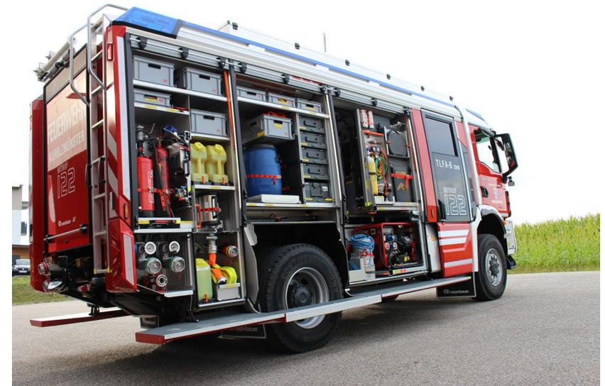
Akkuschrauber, Akkuwinkelschleifer, Akkuschlagschrauber, Akkuäbelsäge mit dem dazugehörigen Zubehör. Zusätzlich wurde hier das Elektrowerkzeug verbaut. Ebenfalls befinden sich im Geräteraum zwei Ölwannen, eine Abdeckplane, Kanaldichtkissen, eine Mülltonne und die Bioversalspritze. Im Auftrittsblech befinden sich die zwei klappbaren Seilwindenkeile.
